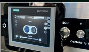
Simple, intuitif et universel, le système Emergency OverRide de Comenda (EOR) permet de passer le fonctionnement en mode mécanique en cas de dysfonctionnement de l'électronique. Cela permet également à l'opérateur le moins expérimenté de réduire les opérations pour configurer le lavage de manière autonome, même en cas de méconnaissance totale de la laveuse.
