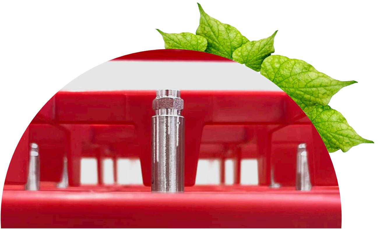
Le circuit hydraulique séparé permettra l'introduction de l'eau dans les buses à l'intérieur du casier (une pour chaque bouteille positionnée).
