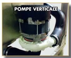
Les pompes surpuissantes, sont toujours adaptées au volume de la cuve. Elles sont autovidangeables et positionnées à l'extérieur.
