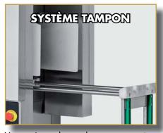
Un système de stockage temporaire retractable permet de ne pas stopper le défilement des plateaux pendant le remplacement du chariot plein en sortie.
