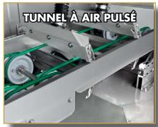
Un séchage à basse température par ventilateur à lames d'air élimine tous les résiduels d'eau de rinçage.
