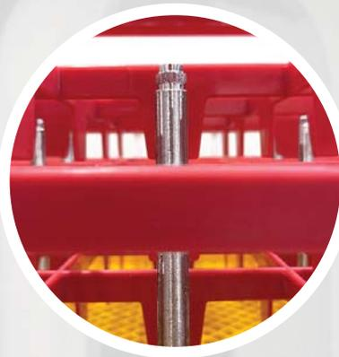
Le circuit hydraulique séparé permet l'introduction de l'eau dans des buses à l'intérieur de chaque bouteille pour un cycle de rinçage qui sera effectué avec de l'eau à une température de 85°C.
